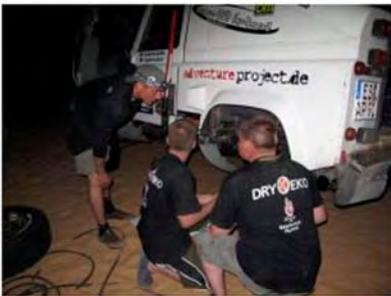
Auch bei uns gibt es dieses Mal leider einiges zu tun - und dadurch auch ein paar recht kurze Nächte. Nach der Dünenetappe am "Verlorenen See" müssen wir einen gerissenen Stoßdämpfer ersetzen (nachdem sich unser Fangband an der Hinterachse unbemerkt verabschiedet hatte).
